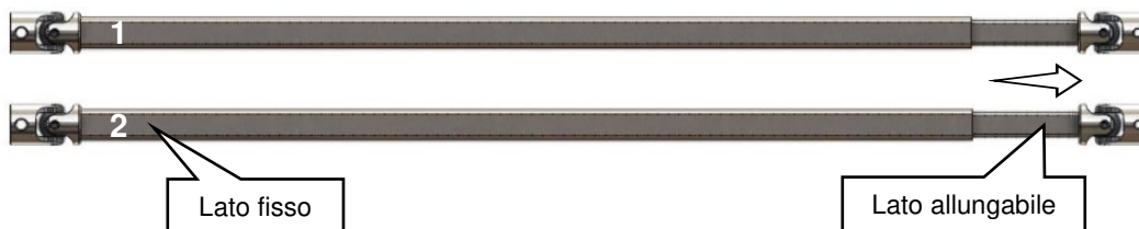
I due alberi di trasmissione allungabili
